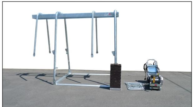
7. Serrer les 2 jambages support / rail puis serrer les vis et les colliers des arceaux.
