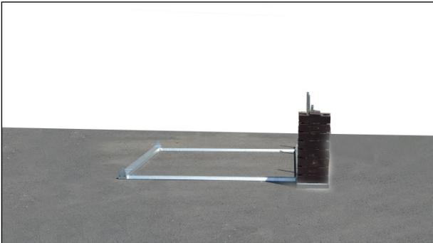
2. Mettre les gueuses en place sur le support (32 gueuses de 25 kg réparties en 4 colonnes, soit 800 kg).
