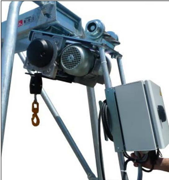
8. Mettre le treuil en place par l'arrière du rail.
