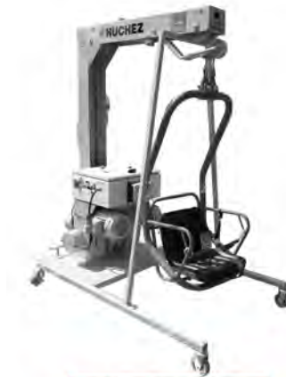
► Sécuritétreuil (2 câbles et 2 treuils indépendants pour une sécurité maximale), 3 hauteurs de travail : 25, 50 ou 70 m.
