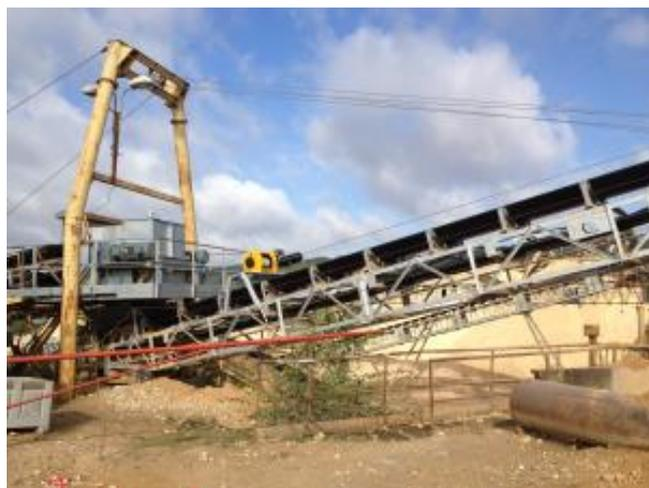
► Treuil électrique INDUSTRIA installé dans des carrières de granulats pour tendre des bandes transporteuses.
