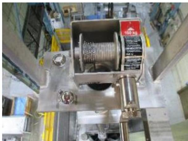
▶ Un treuil manuel MANIBOX VS entièrement INOX utilisé dans une centrale nucléaire lors du changement des grappes de contrôle.
