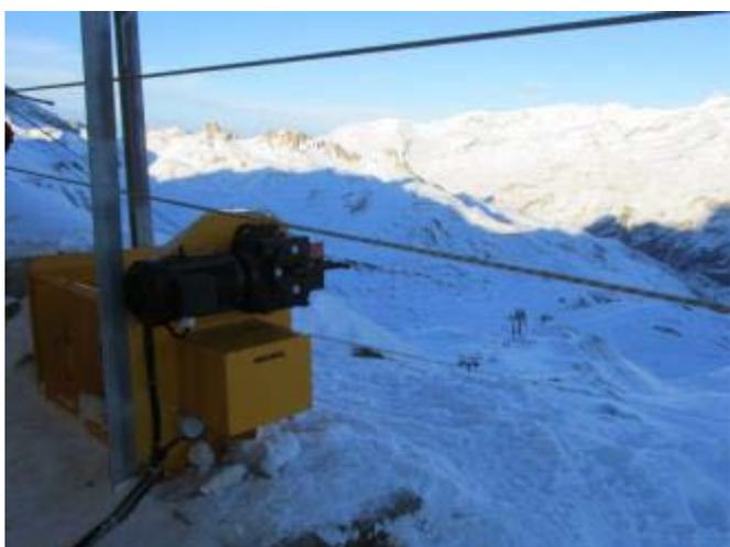
► Treuil utilisé pour ralentir la chute du skieur effectuant un saut à l'élastique sur neige et une fois stabilisé, le descendre en tyrolienne jusqu'au sol.
