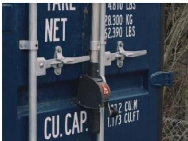
▶ Des treuils manuels HUCHEZ intégrés à un système de lutte contre les feux de containers (HydroPen®).
