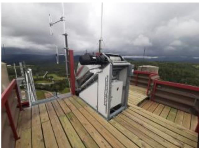
► Treuil électrique PL sur une rampe de saut à skis américaine pour relever la machine permettant de retirer la glace des rails dans lesquels les skieurs se positionnent pour s'élancer du tremplin.
