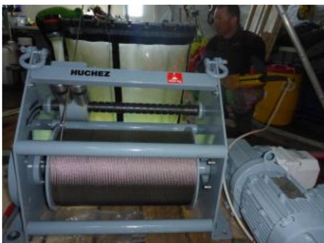
► Treuil utilisé par des scientifiques pour descendre et remonter différents instruments océanographiques (sonde de prélèvement, etc...) lors des missions prévues par leur programme de recherche en Arctique.
