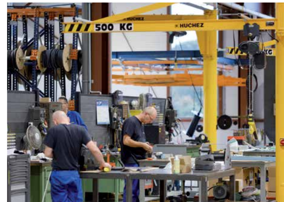
Le fabricant a investi dans des équipements de manutention, tels que des ponts roulants, des potences, des palans, favorisant une réduction des efforts physiques pour ses opérateurs.
