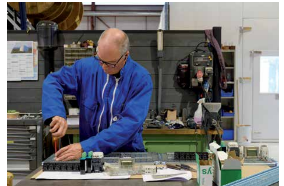
Assemblage de composants pour le câblage électromécanique d'une commande de treuil.
