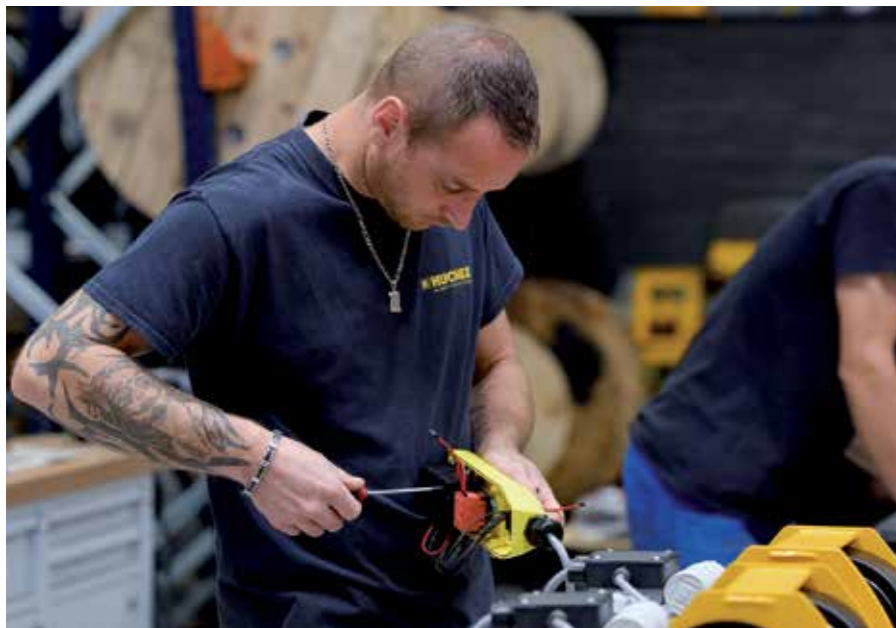
En plein montage de sa boîte à boutons, le treuil électrique compact Motorbox a été conçu pour les applications de levage et de traction simples, pour remplacer par exemple un treuil manuel.
