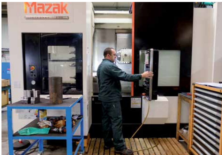
L'entreprise investit régulièrement dans la modernisation de ses équipements, permettant par exemple la programmation d'un tube de tambour fileté pour un treuil Industria 4T sur commande numérique Integrex J300.
