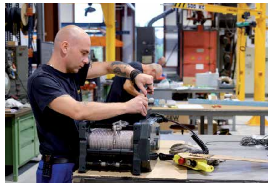
Sur son site de Ferrières, Huchez maîtrise l'ensemble des étapes liées à ses produits, de la conception à la commercialisation, notamment l'usinage des composants et l'assemblage des pièces. Ici, montage d'un treuil électrique compact TRBoxter.
