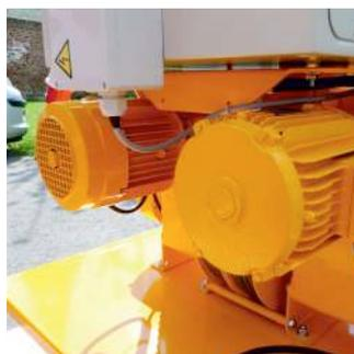
▷ Deux treuils indépendants : l'un assure la fonction levage, l'autre la fonction pare-chute. Les deux treuils sont synchronisés.
