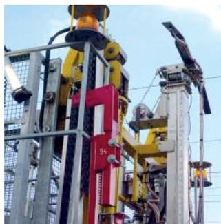
△ Déploiement d'un mât de mise à la terre sur nacelle SNCF.
