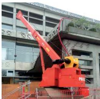
△ Treuil installé sur une grue de puisatier.
