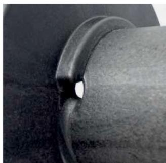
▶ Guidage de bon enroulement du câble.
