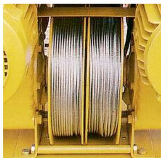
▷ Deux câbles indépendants disposant d'une charge de rupture de 1600 kg chacun (coefficient de sécurité égal à 10).
