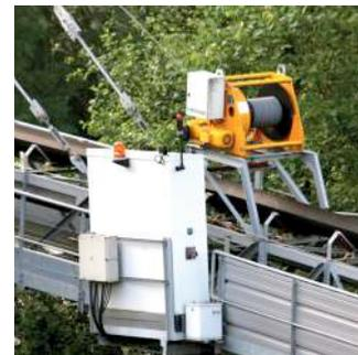
▷ Relevage d'une bande convoyeuse pour le chargement de péniches.
