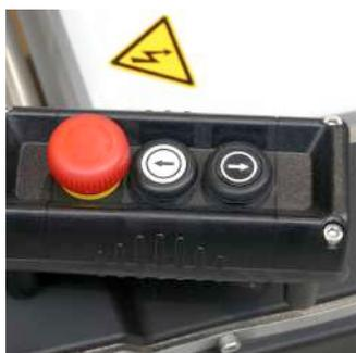
△ Boîte de commande IP 66. Câble électrique de type marine sans halogène. Prise de type Harting, protection IP66.
