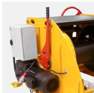
Débrayage manuel du tambour à vide, ergonomique et sécurisé. Frein manuel à bande de retenue.
