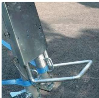
△ Platine de fixation pour faciliter l'installation du treuil.
