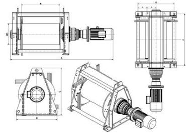
Treuil électrique 8000 kg. Gamme de treuils électriques dotés d'une grande capacité d'enroulement de câble et développés pour répondre à des utilisations intensives en environnement sévère pour les applications de levage et traction/halage.
